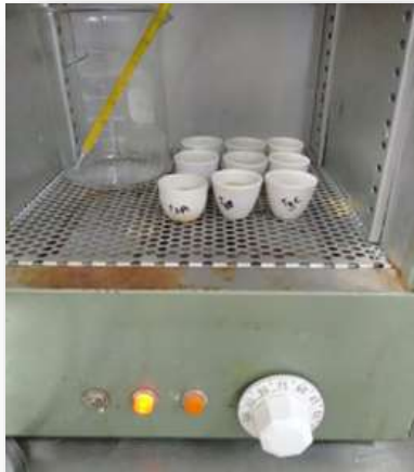
Figura 14. Determinación de humedad
